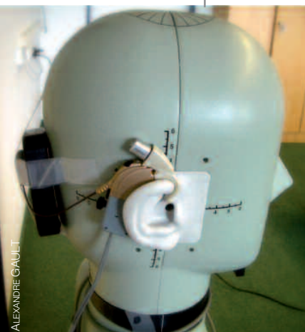
Figure 3 : Mannequin de K.E.M.A.R équipé d'un système d'implant cochléaire connecté à un système FM.
